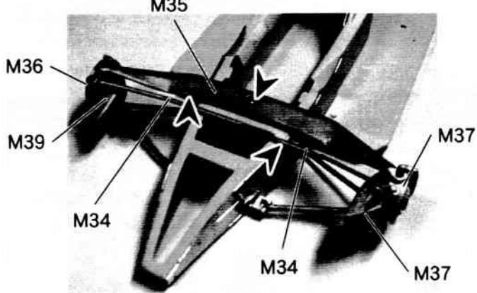
R02とM35の固定は中ネジを用いて下さい。
