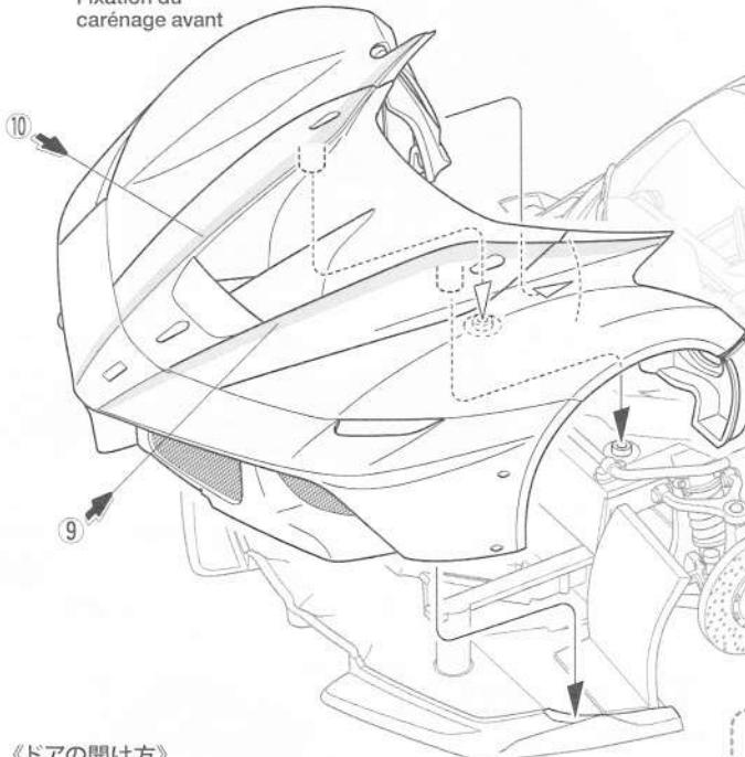
★図のようにツメが開口部から出ている事を確認し、前側にスライドさせます。
